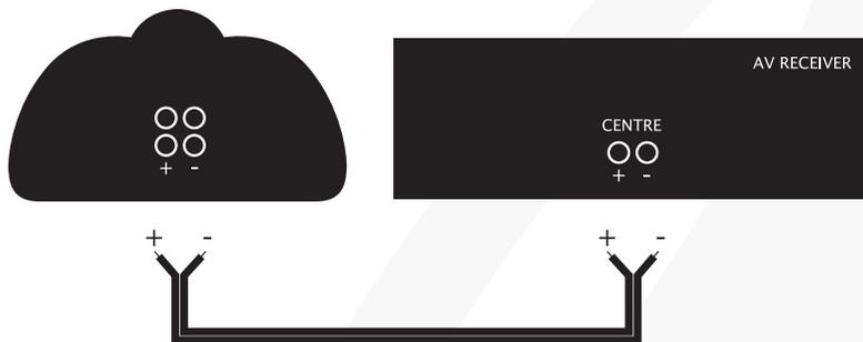
Les bornes serre-fils acceptent les conducteurs de Ø 4 mm au maximum. Assurez-vous que les bornes serre-fils positives du CinePod (+) soient connectées aux bornes serre-fils positives de sortie de l'amplificateur et les bornes serre-fils négatives (-) aux bornes serre-fils négatives de sortie de l'amplificateur.
